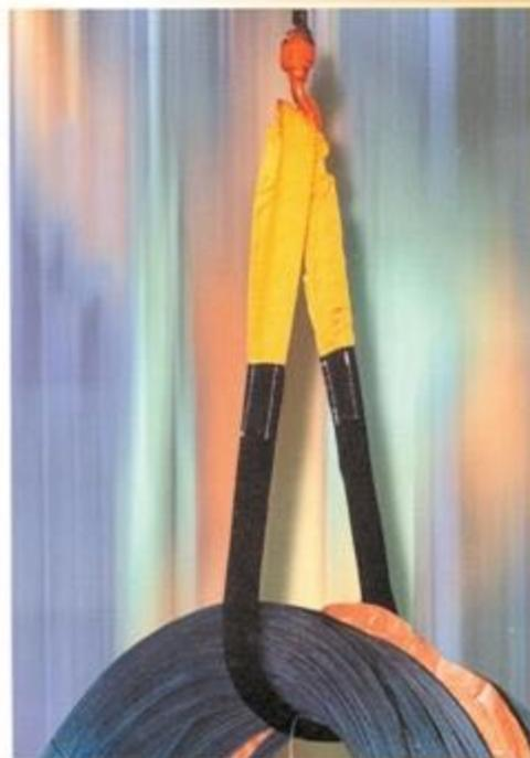
Las **Eslingas** redondas sin - fin pueden ser fabricadas con una configuración de ojo-ojo. Para aplicaciones normales se utiliza una capa de poliéster como forro para cubrir la **Eslinga**, dejando un ojo en cada extremo. En aplicaciones donde exista una mayor abrasión se utiliza ya sea doble capa de poliéster muy resistente o cuero para reforzar los ojos.
