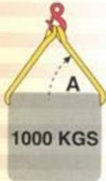
Una **Eslinga** con capacidad de levantar 1000 kilogramos en un arreglo vertical de 90 grados, solamente podrá levantar lo siguiente con el efecto **Eslingas** en ángulo horizontal.
